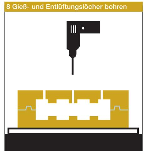
– Falls nicht bereits Röhren oder Stifte als >Platzhalter für Gieß- und Entlüftungslöcher eingelegt wurden: zum späteren Einfüllen des >Reproduktionswerkstoffes an geeigneten Stellen Löcher bohren.
